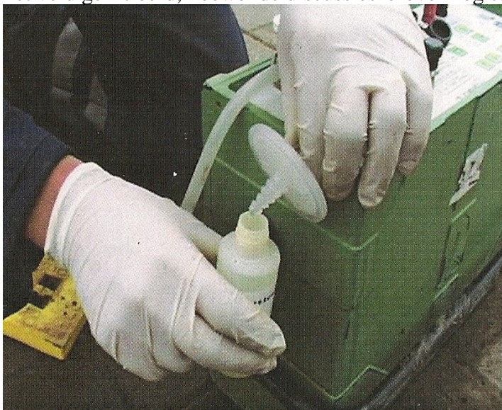
Figuur 1.2 Filtratie van grondwater
